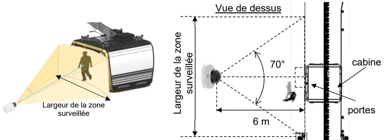
Quand une cabine se présente à la gare CHU, le quai est filmé par une caméra positionnée à une distance de 6 mètres face aux portes de la cabine. Son angle de vue horizontal est de 70°.
