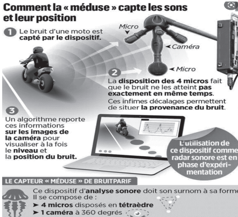
Figure 2. Fonctionnement du dispositif « méduse ». https://www.leparisien.fr/
